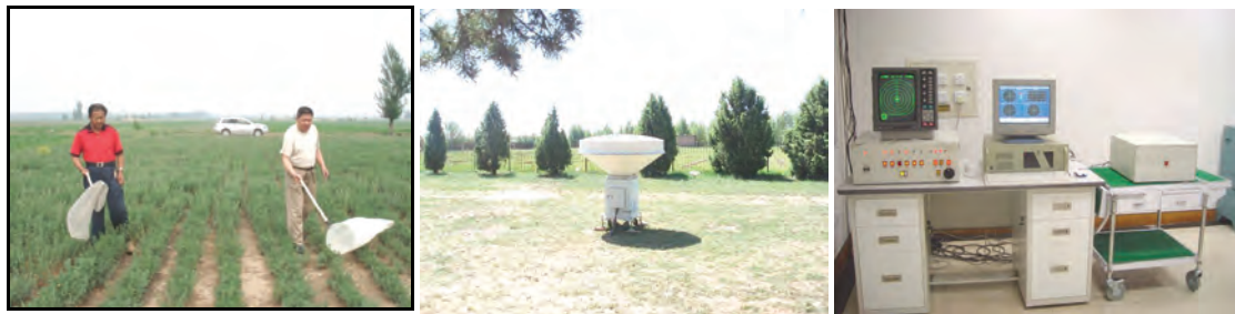
Рис. 2. Учеты численности лугового мотылька в КНР (слева) радар-трансивер и система обработки сигнала (слева), используемый для мониторинга миграций насекомых в КНР
