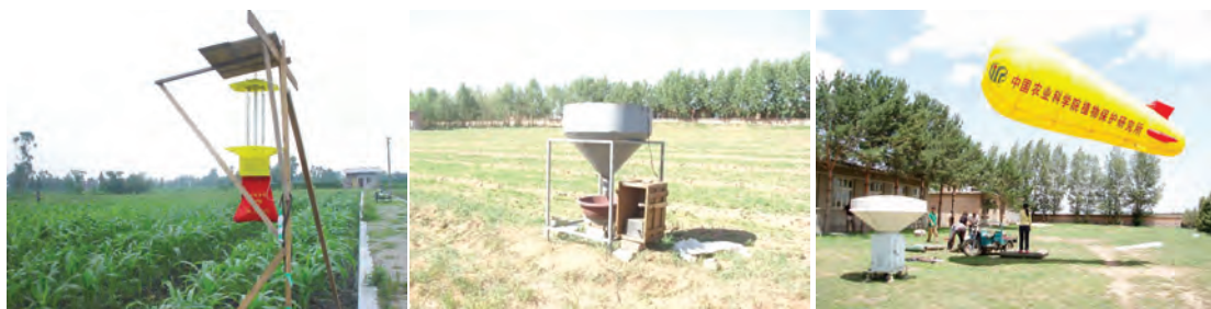
Рис. 3. Оборудование, используемое для диагностики видовой состава мигрирующих насекомых (светоловушки наземного базирования и аэростаты).
